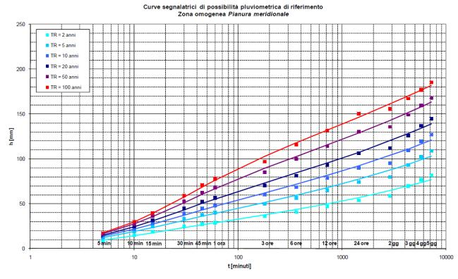
Figura 9: Curve segnalatrici di possibilità pluviometrica per la zona omogenea Pianura meridionale (Fonte: PGBTT del Consorzio di bonifica Adige Euganeo)
