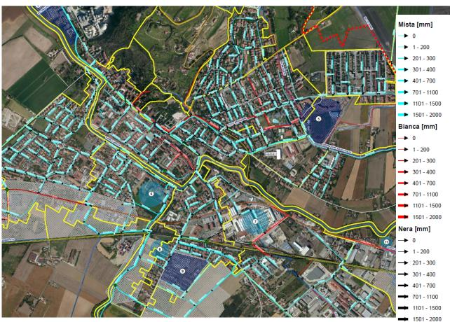
Figura 19: Rete fognaria mista nel centro di Este da Piano delle Acque "TAV6\_Fognatura"
