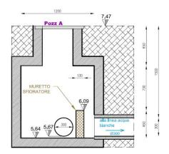
Figura 21: Sezioni manufatto sfioratore n. 1 (fonte dati CVS)
