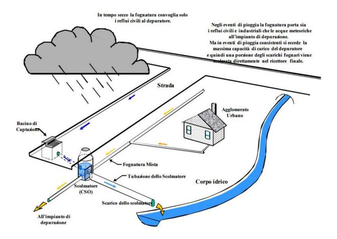
Figura 22: Schema funzionamento fognatura mista
