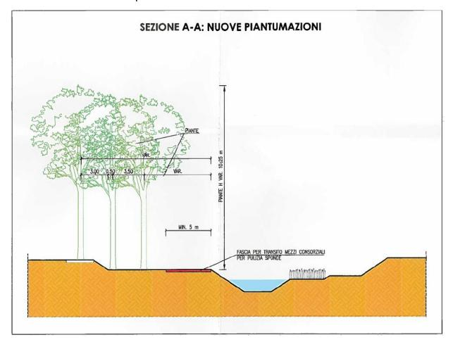
Figura 54: Sezione tipo del progetto di piantumazione del Canale Meggiaro
