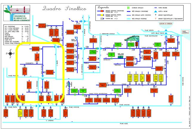
Figura 18: Quadro sinottico della rete idraulica del Consorzio di Bonifica Adige Euganeo
