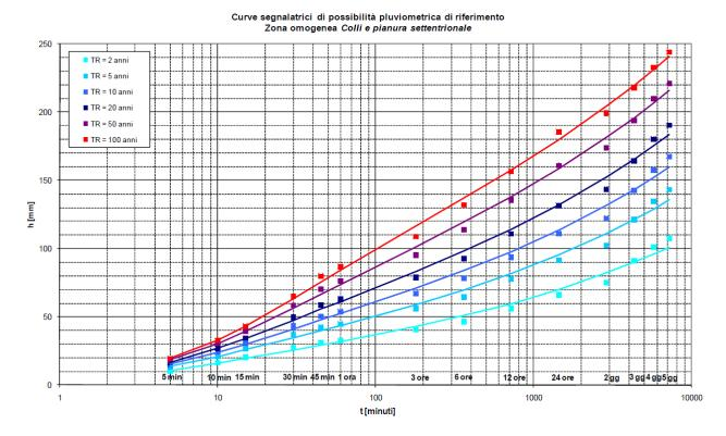
Figura 8: Curve segnalatrici di possibilità pluviometrica per la zona omogenea Colli e pianura settentrionale (Fonte: PGBTT del Consorzio di bonifica Adige Euganeo)
